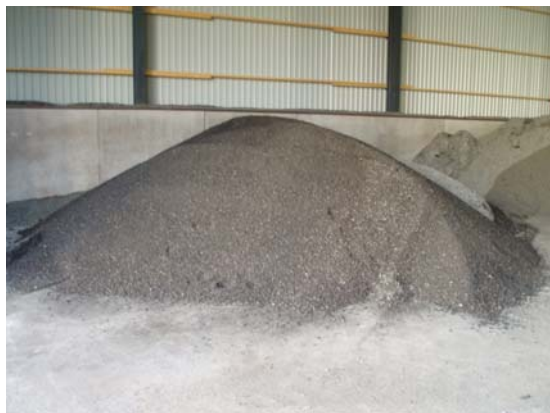
Bild 3-12 FRA som legat några månader föll lätt isär. Inga tecken på avrunnen olja kunde observeras. Materialet kändes som nykrossad asfalt enligt lastmaskinisten.
