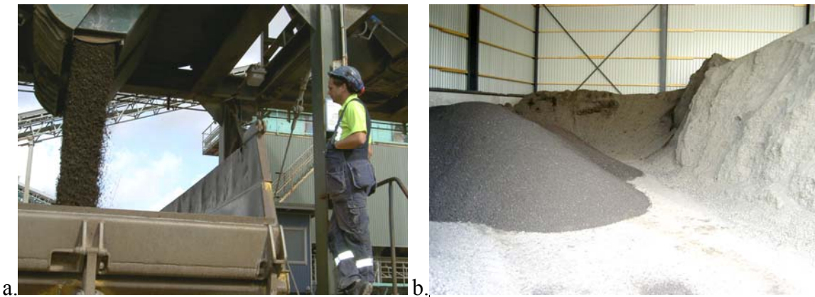
Bild 3-11 Efter viss väntan rann FRA ut ur fickan och förvarades sedan under tak i några månader, innan materialet inspekterades och kom till användning i fullskaliga försök.
