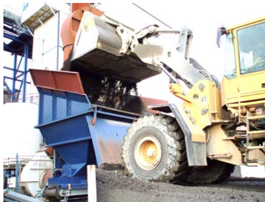
Bild 3-12 FRA som legat några månader föll lätt isär. Inga tecken på avrunnen olja kunde observeras. Materialet kändes som nykrossad asfalt enligt lastmaskinisten.
