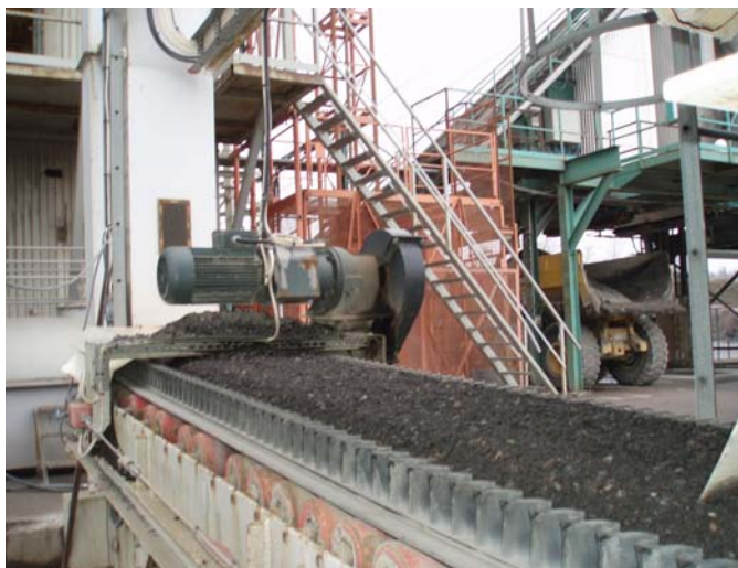
Bild 3-13 ROD hälldes över RA/FRA på det öppna matarbandet medan bandet gick 15-20 sekunder för varje sats.
