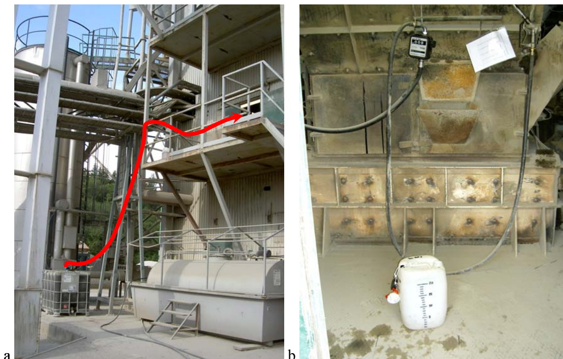
Bild 3-6 Med motordriven fatpump fylldes en graderad dunk, som tömdes satsvis genom asfaltblandarens doseringslucka.
